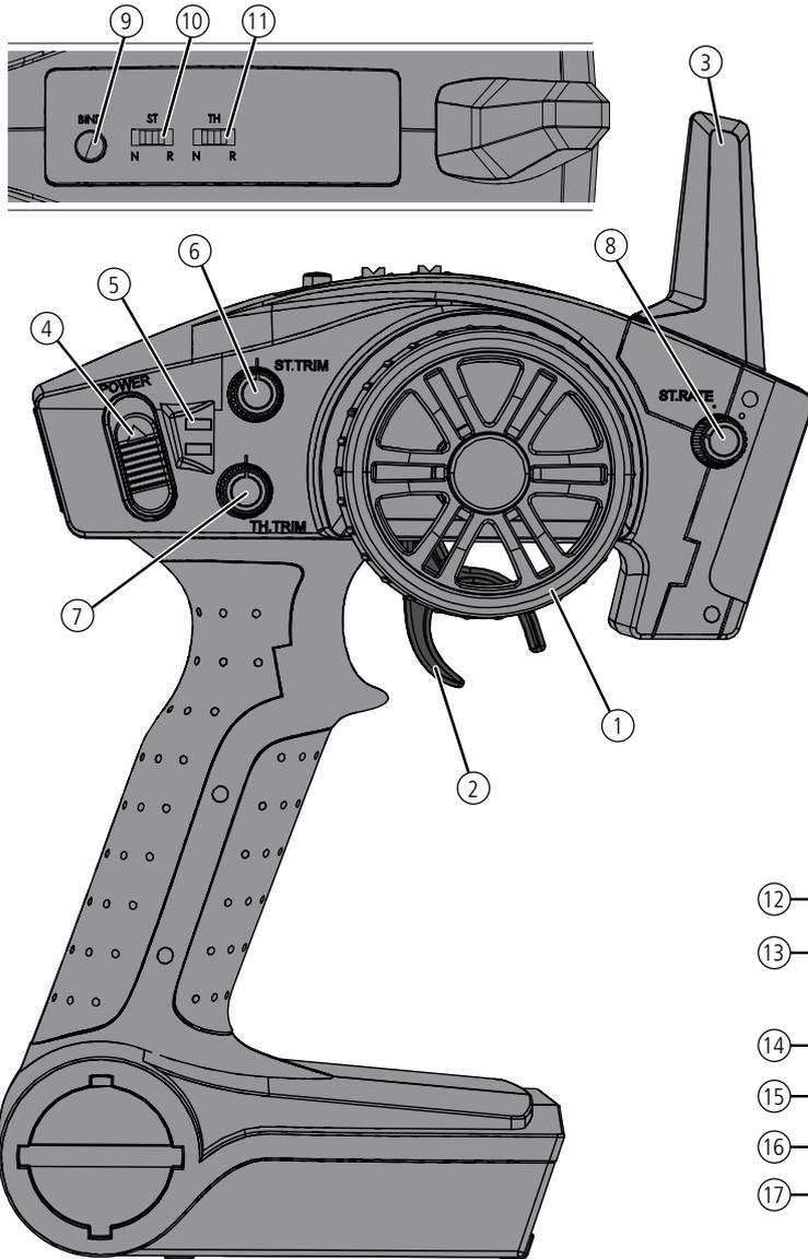
1. **Lenkrad** Steuert die links / rechts Richtung des Modells
