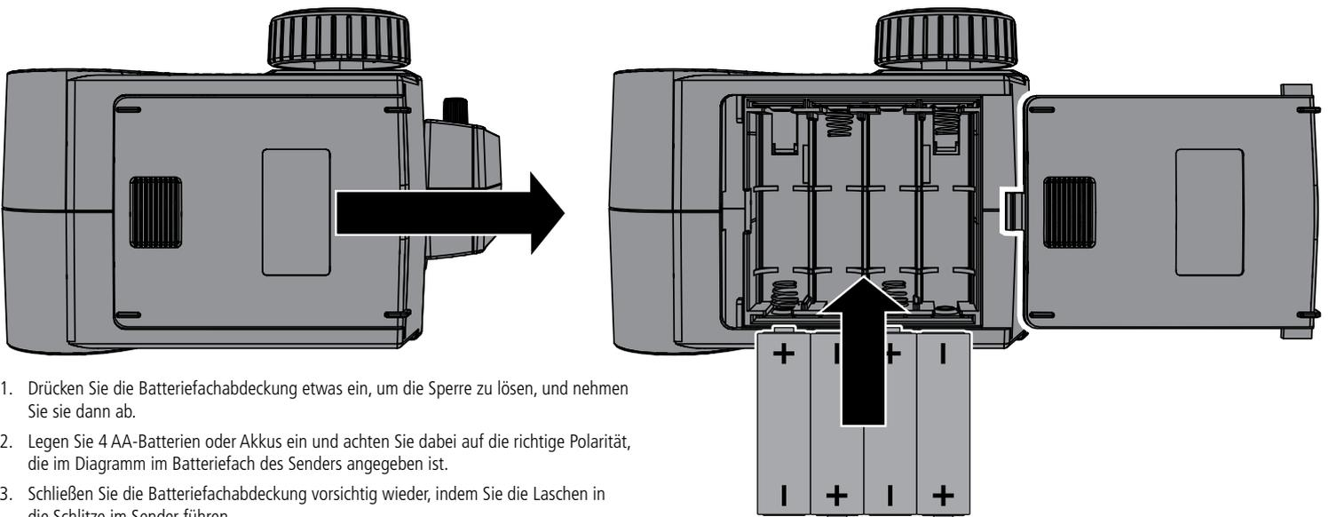
1. Drücken Sie die Batteriefachabdeckung etwas ein, um die Sperre zu lösen, und nehmen Sie sie dann ab.
